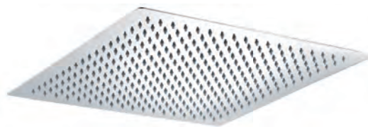
Ref. : RDC004 Dimensiones 40X40cm Rociador Cuadrado Extraplano Material : Acero Inox S304 Acabado : Cromado
